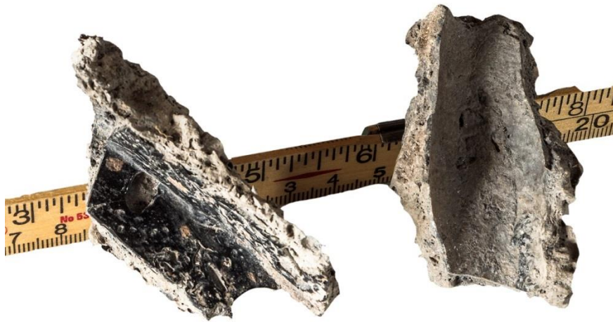
Slaggavslag efter den hake med vilken smältaren avlägsnade den stelnde slagen från slaggsumpen. Se bild nedan!
