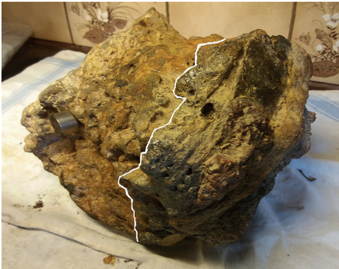
Järnsmälta fastbränd på ugnsinfordring.
